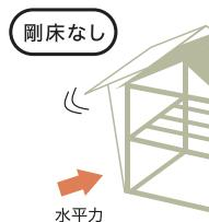
床の耐性が低いと、地震などの水平力に対してねじれが生じやすい。
